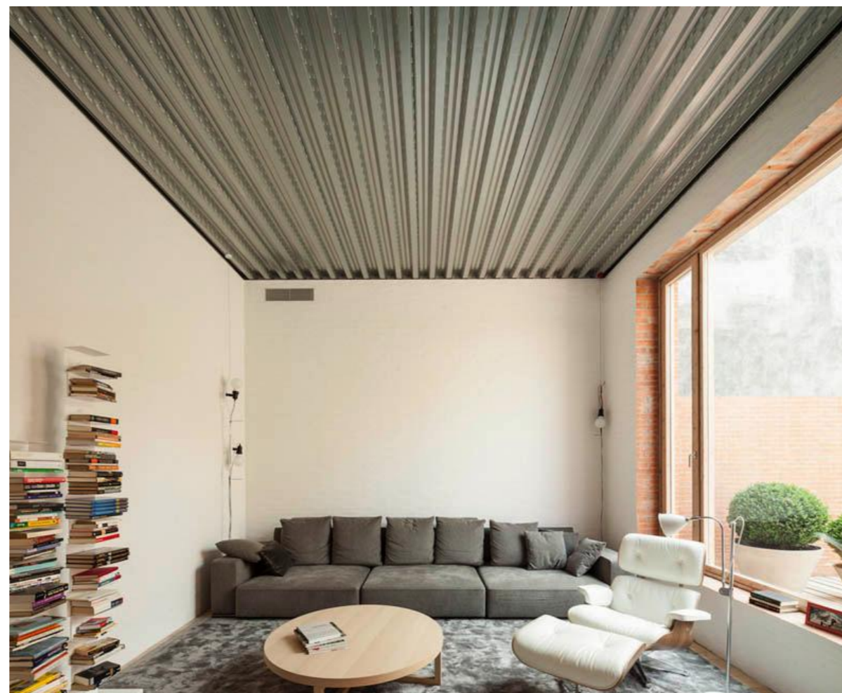
Plancher intermédiaire collaborant - sous-face métal
