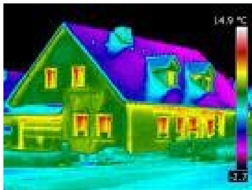
Thermographie infrarouge permettant de relever les pertes de chaleur sur un bâtiment
